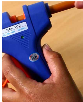
LANGKAH 2 Masukan Lilin Batang ke dalam Alat Lem Tembak
